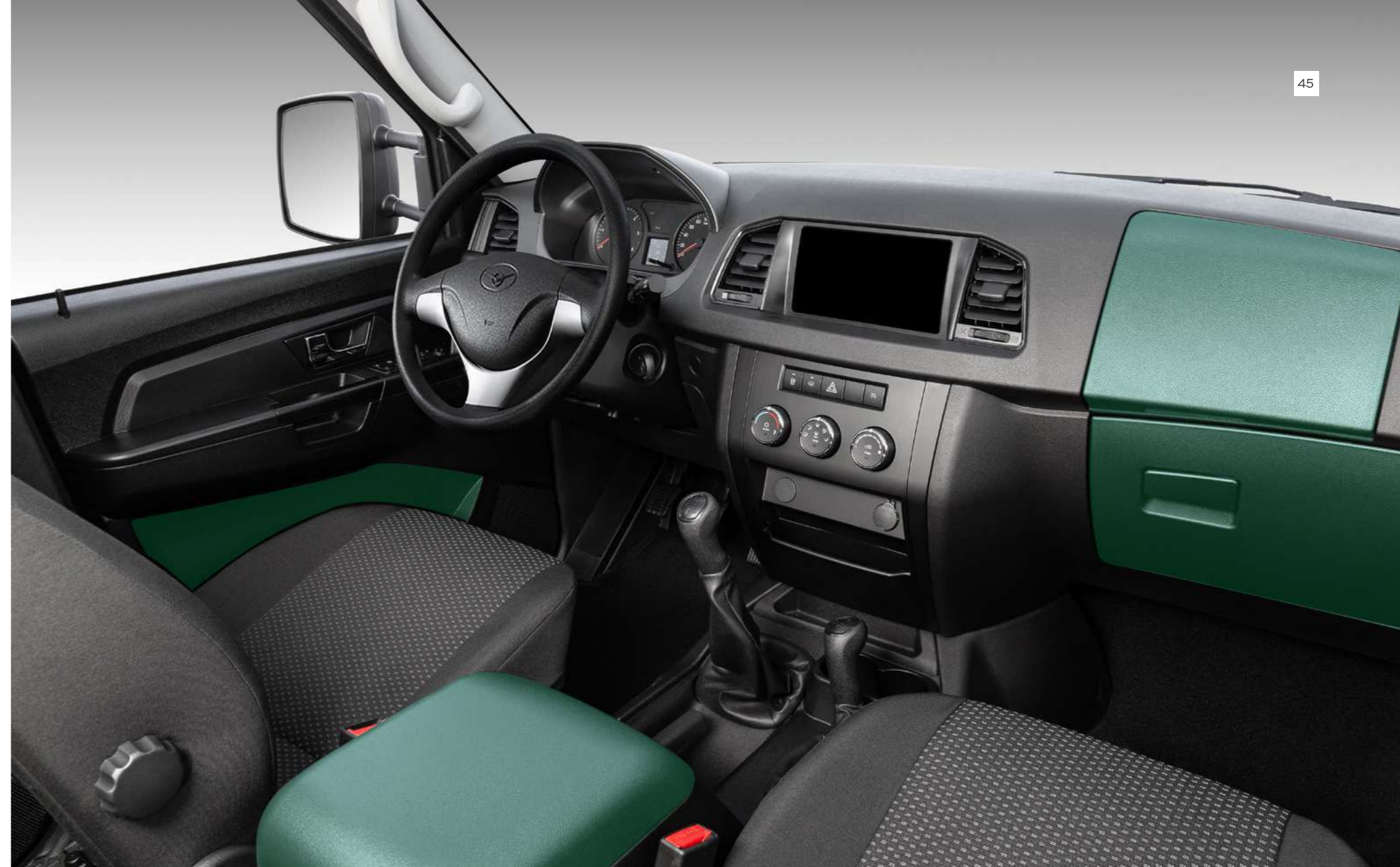
Боковые карманы в дверях, верхний и нижний вещевые ящики, вместительный бокс между передними сиденьями (для версии 4x4)
