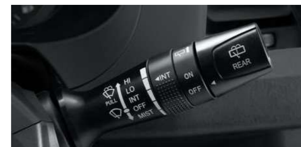
Правый подрулевой переключатель с регулировкой паузы стеклоочистителя
